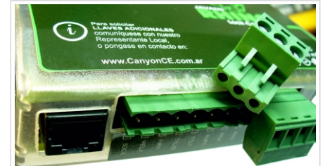
Panel de Conexiones, RJ45 Antena Externa, 11 Borne Enchufables para Cerraduras, Sensores, Energía auxiliar, etc.
