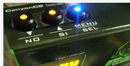
HMI (Human Machine Interface) a bordo, permite la comunicación con el sistema, sin necesidad de equipos externos
